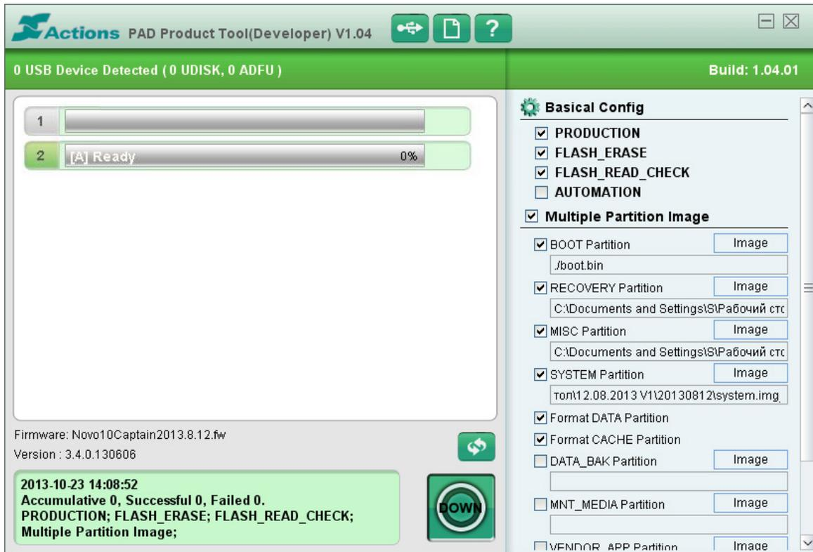
14. Начнется процесс прошивки. У некоторых этот процесс может отображаться во 2-м, 3-м, 4-м и т.д. пункте. Зависит от того, сколько раз перепрошивались. Не стоит обращать на это никакого внимания. Время прошивки займет около 2-х минут.
