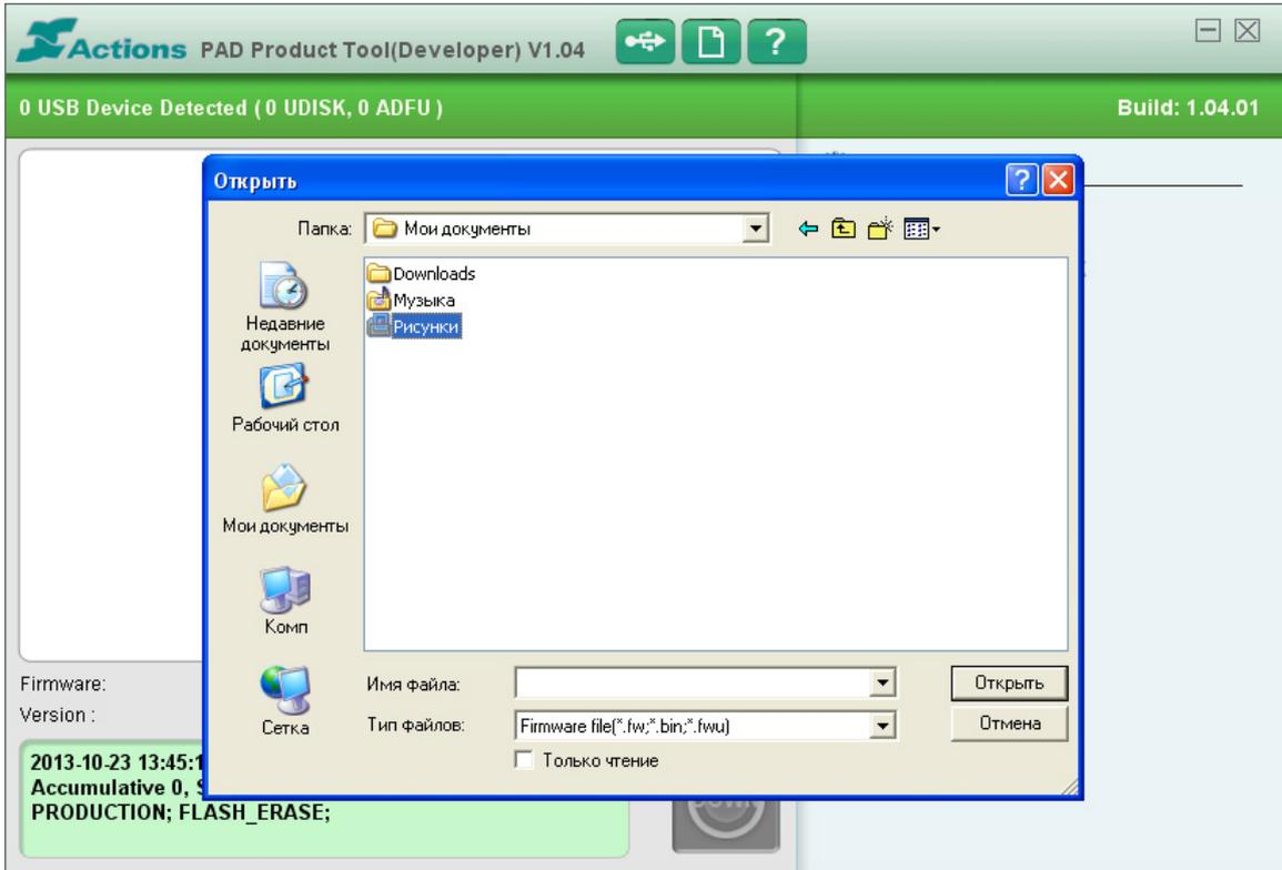
4. Если этого не произошло или вы уже до этого прошивались то нажимаем на зелененькую кнопочку с двумя стрелочками. Заходим в папку куда распаковали прошивку и выбираем нужный нам файл прошивки.
