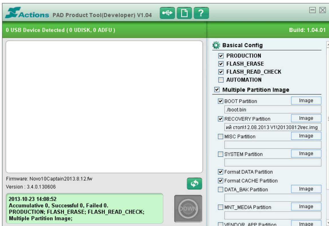
8. Нажимаем на кнопку "Image" напротив MISC Partition и выбираем файл misc.img из папки с прошивкой.
