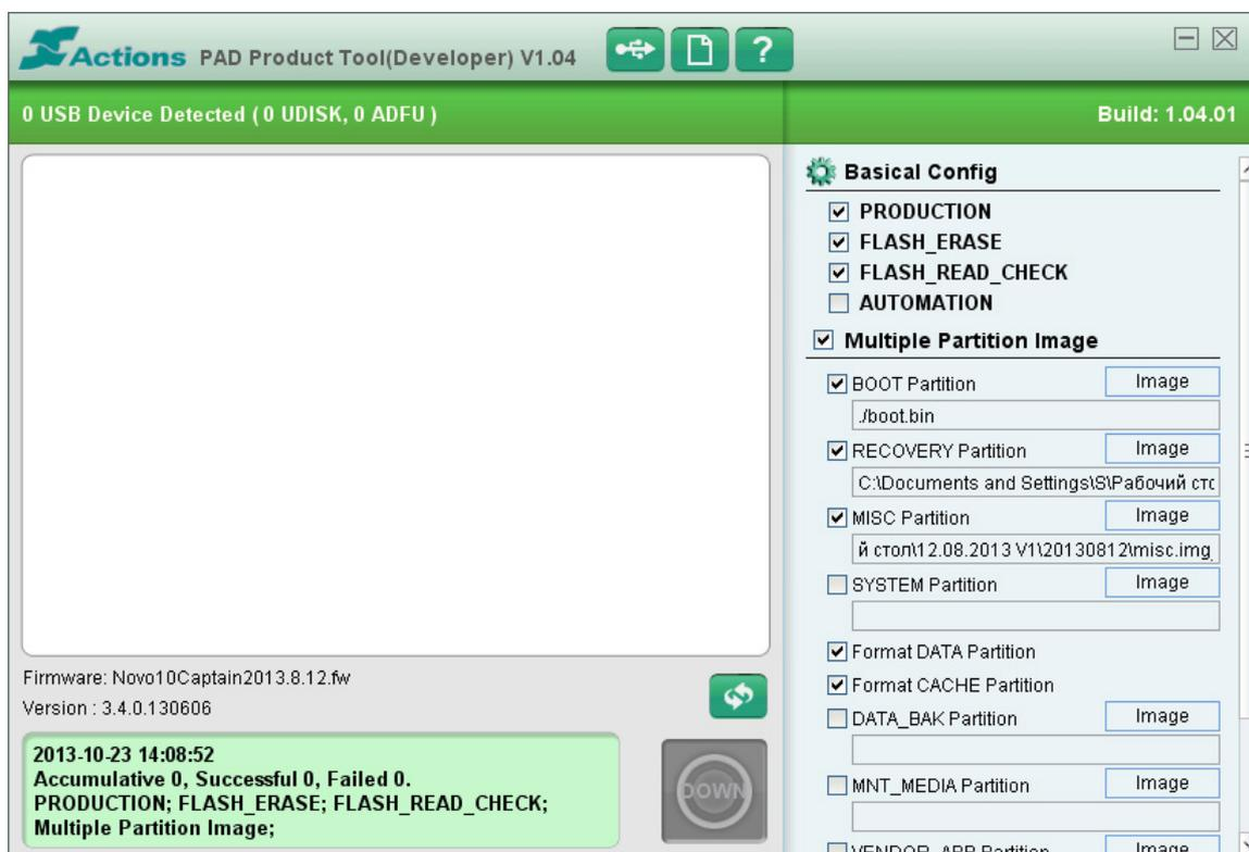
9. Нажимаем на кнопку "Image" напротив **SYSTEM Partition** и выбираем файл **system.img** из папки с прошивкой.
