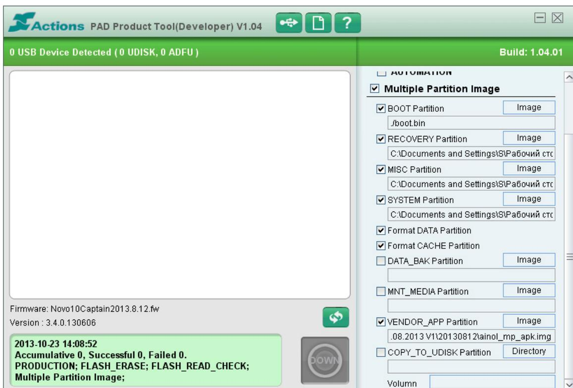
11. После пункта **SYSTEM Partition** проверяем галочки **Format DATA Partition** и **Format CACHE Partition**, если их нет, то устанавливаем.
