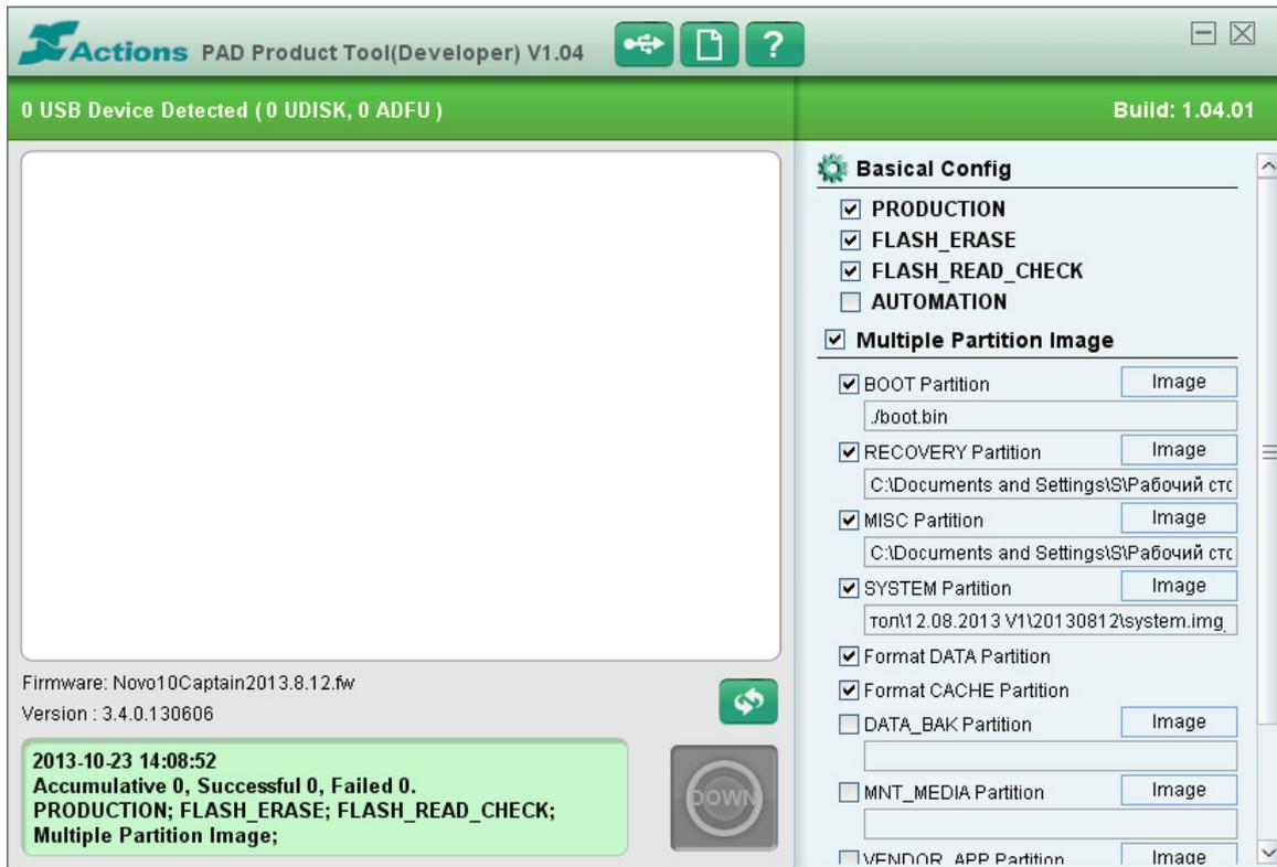
12. Переходим в окно утилиты **Actions PAD Product Tool**. Выключаем планшет. Зажимаем на нем кнопку **Громкость +** и удерживая её подключаем планшет к порту USB компьютера. Если кнопочка **DOWN** (которая раньше была серой) стала зеленой, значит устройство готово к прошивке.
