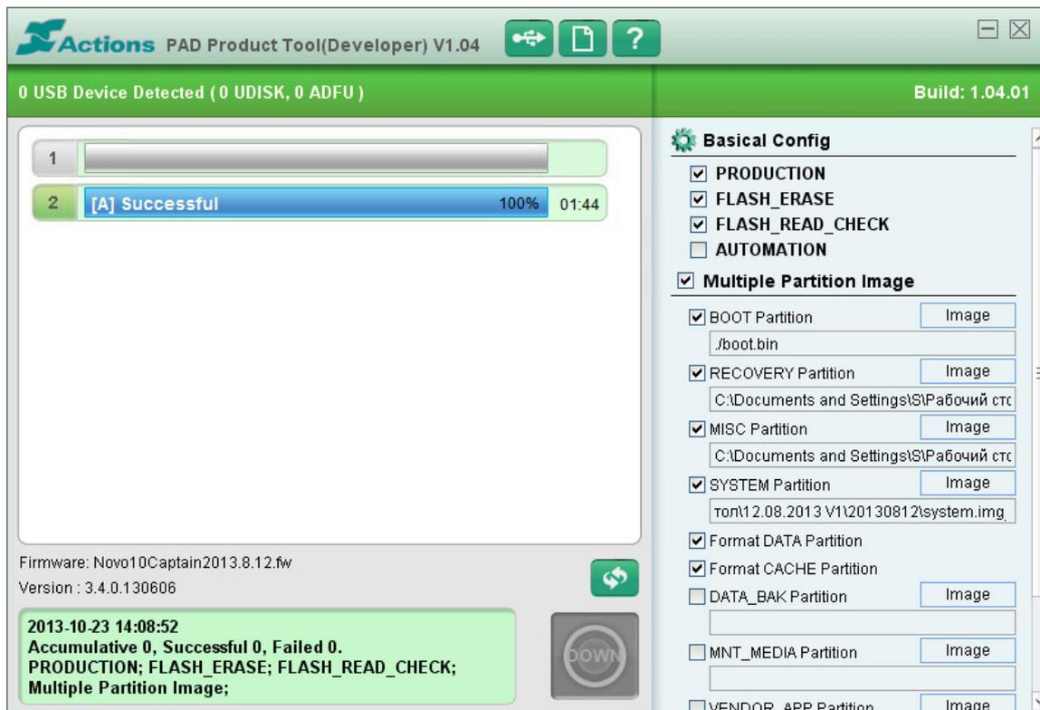
16. Отсоединяем кабель от планшета. Нажимаем на кнопочку включения и удерживаем ее секунд 20 и отпускаем. Должна начаться загрузка. Первая загрузка длится примерно 2-3 минуты.
