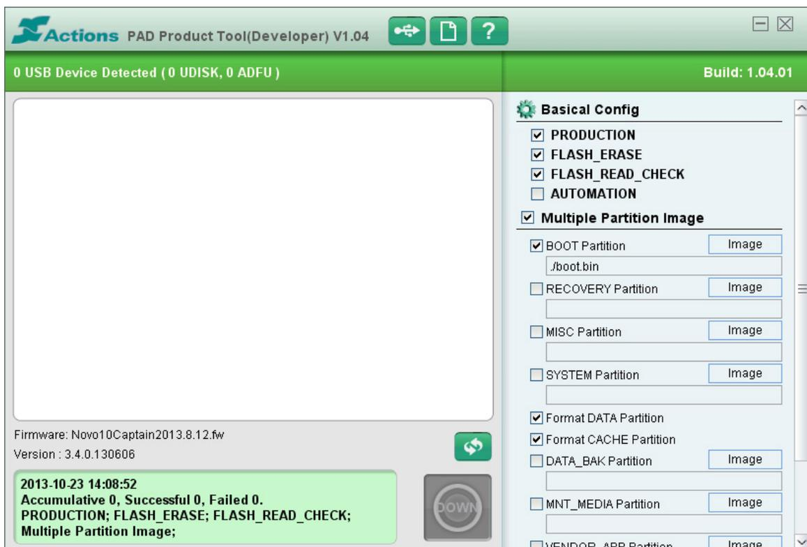
7. Нажимаем на кнопку "Image" напротив RECOVERY Partition и выбираем файл rec.img из папки с вашей прошивкой.
